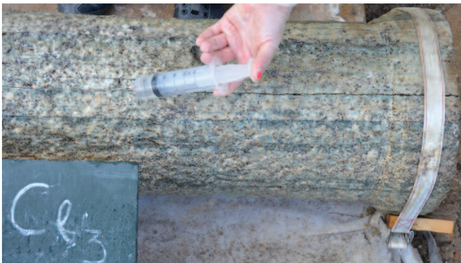
Εικ. 77. Κίονας Cl 3: ρήγμα και λεπτές παράλληλες ρηγματώσεις.
