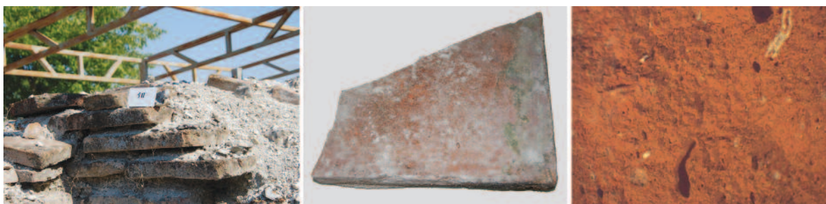
Εικ. 74. Φωτογραφία δειγματοληψίας, μακροσκοπική και μικροσκοπική οπτοπλίνθου (κωδικός αριθμός δείγματος Π1).
