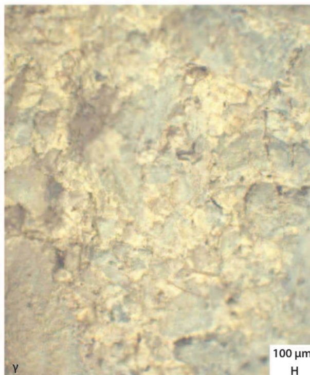
Εικ. 71. Φωτογραφία δειγματοληψίας, μακροσκοπική και μικροσκοπική, κονιάματος δόμησης (κωδικός αριθμός δείγματος 7).
